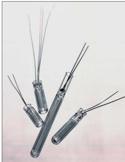
Bild 1: Auf Grund der bis aufs zehntel Grad genormten Kennlinie von Pt100-Sensoren ist kein Chargenabgleich bei der angeschlossenen Auswertungs-Elektronik nötig. Das historische Foto zeigt Platin-Sensoren aus dem früheren 20. Jahrhundert.
